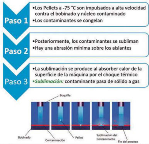
Figura 4. Explicación del proceso de limpieza criogénica.
