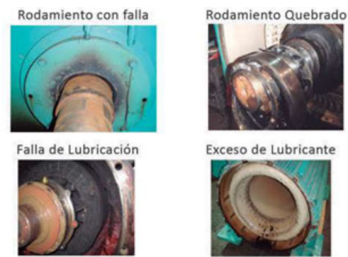
Figura 5. Fallas mecánicas en aerogeneradores.
