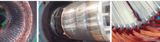
Figura 5. Daños típicos en núcleos laminados.
